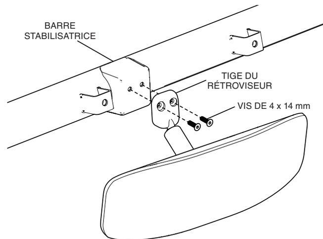
2. Serrer les vis au couple spécifié dans le tableau des couples.
